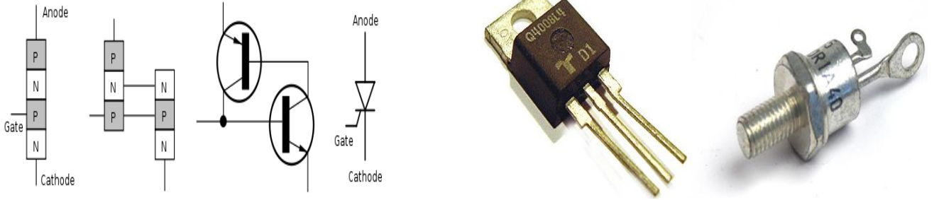
شكل (٣-٣٥) يبين اشكال ورمز الثايرستور
