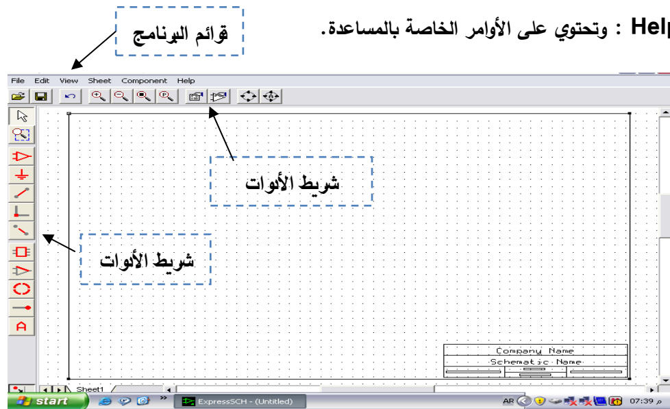
الشكل (١-٤): واجهة المستخدم لوحدة تصميم مخطط رسم الدوائر النظرية Schematic لبرنامج ExpressPCB
