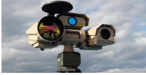
تعتبر انواع كاميرات المراقبة هذه من الطرازات المكلفة وهي ليست عامة وإنما تستخدم في المنشآت الخاصة، وتعتمد في إنتاج الصور على الأشعة الحرارية لذلك من الصعب إخفاؤها عن العيان، حيث تظهر الصورة بألوان متعددة وفقاً لدرجة حرارة الهدف، وغالباً ما يُستخدم هذا النوع في العمليات العسكرية ولإلقاء القبض على الهاربين ليلاً.
