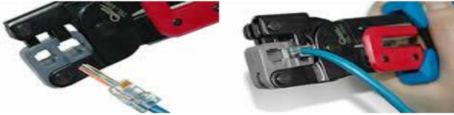
لتجعيد الموصل أدخل مجموعة الموصل / الكبل المعدة في فتحة RJ45 في أداة الكبس. اضغط بقوة على مقابض اداة التكنيش معًا حتى تضمن توقعها عن الضغط. حرر المقابض وكرر هذه الخطوة لضمان التكنيش المناسب.
