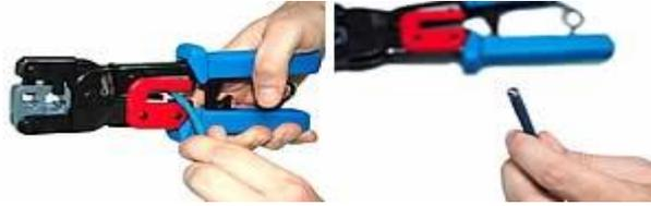
اقطع الكبل باستخدام أداة التجعيد او بأستخدام أداة القص ، قم بتقليم نهاية الكبل الذي ستقوم بتوصيلة بـ RJ45 ،
