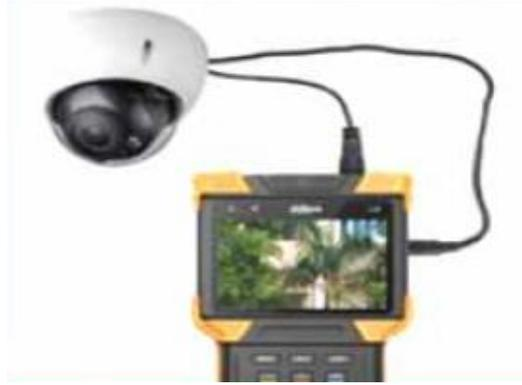
هو عبارة عن جهاز به بعض الفتحات التي يمكن توصيله بالكاميرا وبه شاشة عرض لتعرض الصورة على الشاشة الموضحة بالشكل حيث أن الكاميرا يخرج منها عدد ٢ كابل أحدهم لنقل الداتا وعرضها على شاشة الـ ( TESTER ) والآخر هو الذي يمد الكاميرا بالكهرباء من ( TESTER ) أي أن ( TESTER ) يعتبر في هذه الحالة هو مصدر الكهرباء للكاميرا وعند توصيل الجهاز بالكاميرا والضغط على ضاغط ( Power ) للجهاز يعرض صورة الكاميرا تلقائيا أي أن الكاميرا سليمة وأيضا الكابل سليم .
