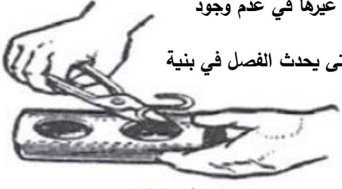
القص: هو أحد أساليب قطع وتشكيل الأسطح المعدنية والتي تتميز عن غيرها في عدم وجود ريش نتيجة تغلغل حدى القطع في المعدن نتيجة لقوة الضغط عليهما حتى يحدث الفصل في بنية المعدن ويستخدم في عمل التفريغ بالقص أنواع من المقصات اليدويه لكل منهم إستخدامه وفقاً لنوع القص المطلوب.
