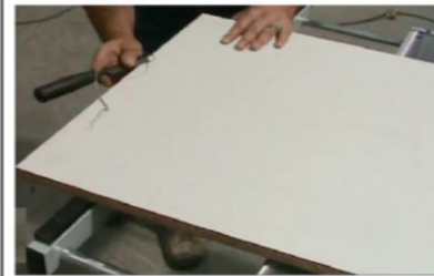
ازالة الزيادات بطريقة يدوية باستخدام أزميل عريض
