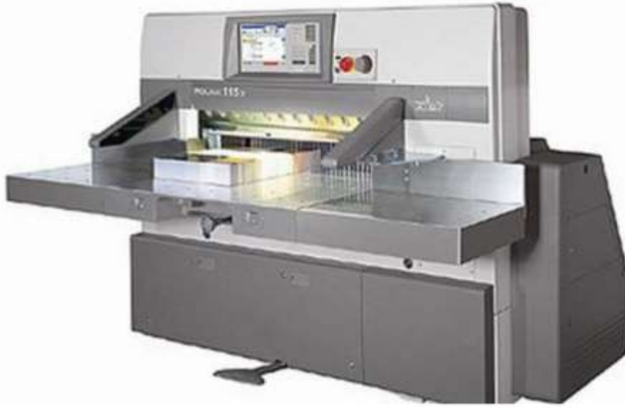
شكل يوضح المقصات احادية النصل
