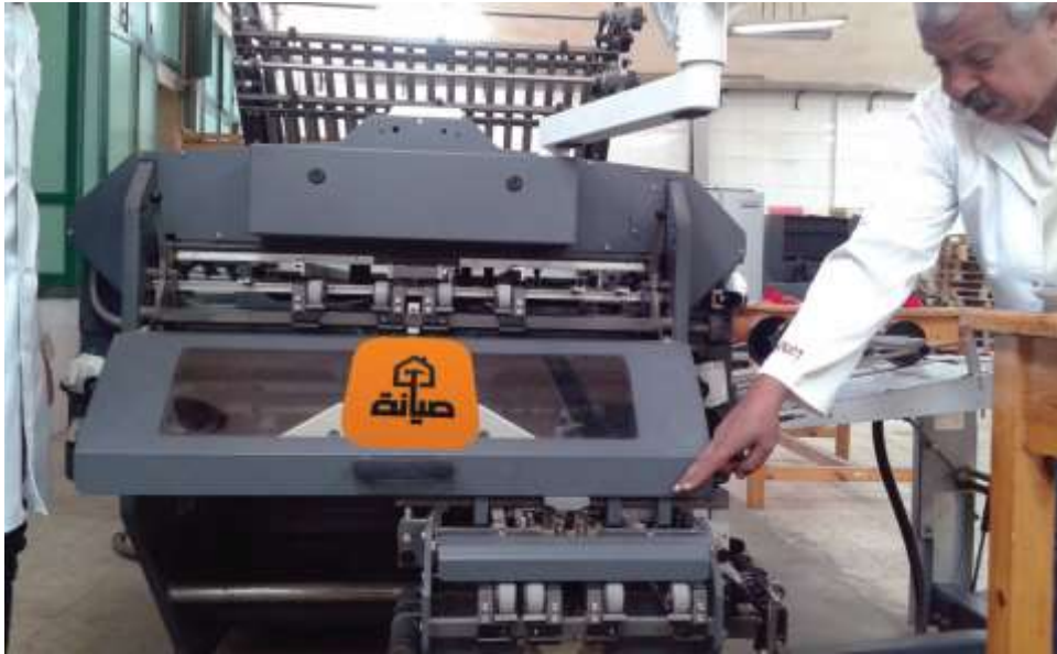
شكل يوضح وضع اللوحات الإرشادية على المعدات الخاضعة لعمليات الصيانة
