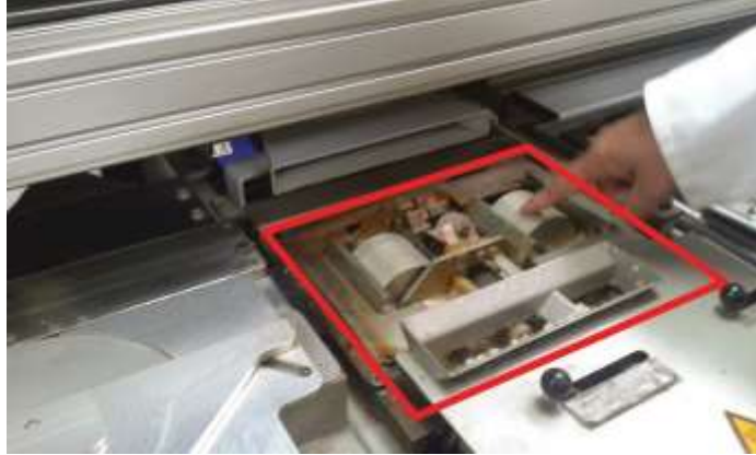
شكل يوضح وعاء صهر المواد اللاصقة لماكينات البشر والتغيرية
