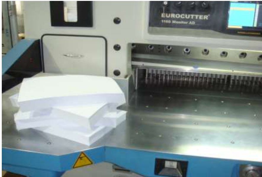
شكل يوضح طاولة المقص من الصلب الغير قابل للصدأ
