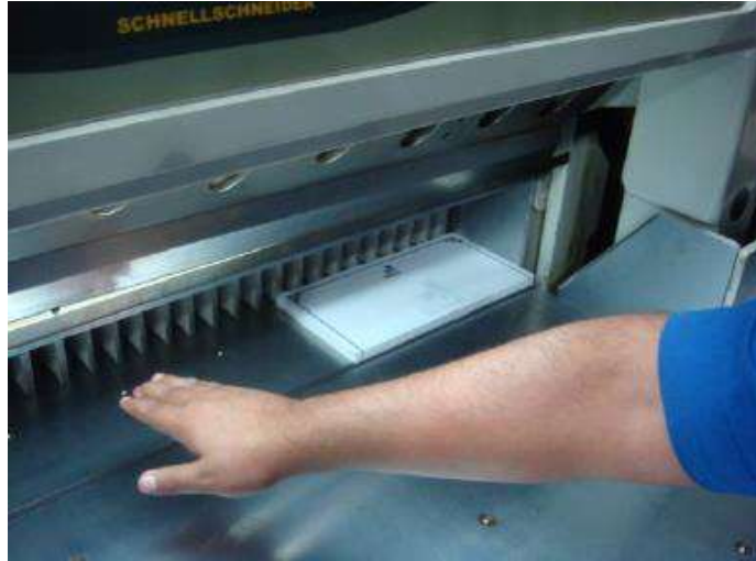
شكل يوضح اقتراب الأيدي من سكين المقص أثناء التشغيل
