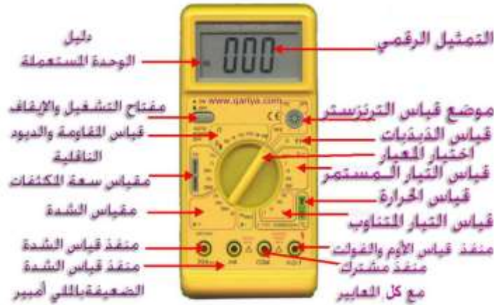
شكل 7: وصف جهاز القياس متعدد الأغراض-المليتي미터
