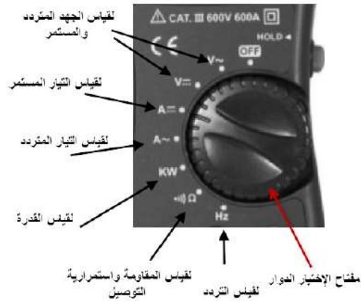
شكل 13: مفتاح الاختيار الدوار لجهاز الكلامبميتر
