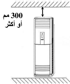
شكل (٣) يوضح المسافة العلوية المتروكة بين الوحدة الداخلية واقرب جسم
