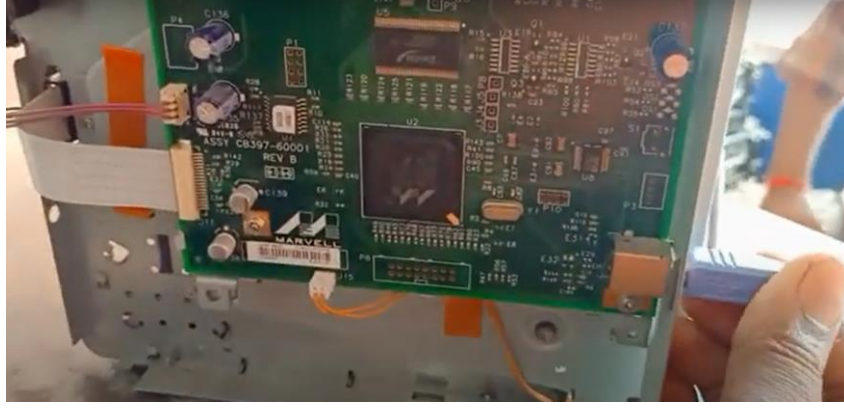
الشكل التالي يمثل لوحة المنسق ( Formater Board ) لطابعة HP M433
