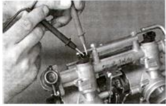
شكل (١-٣٨) قياس مقاومة صمام الحقن
