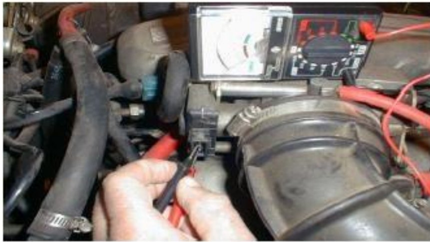
شكل (١-٣٩) فحص حساس تدفق الهواء
