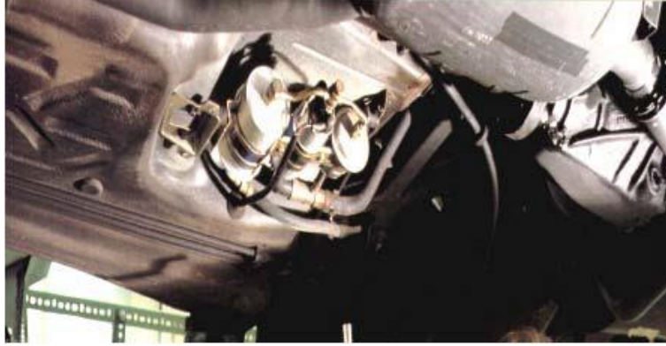
شكل ( ١-٣٦ ) مضخة الوقود والفلتر خارج الخزان
