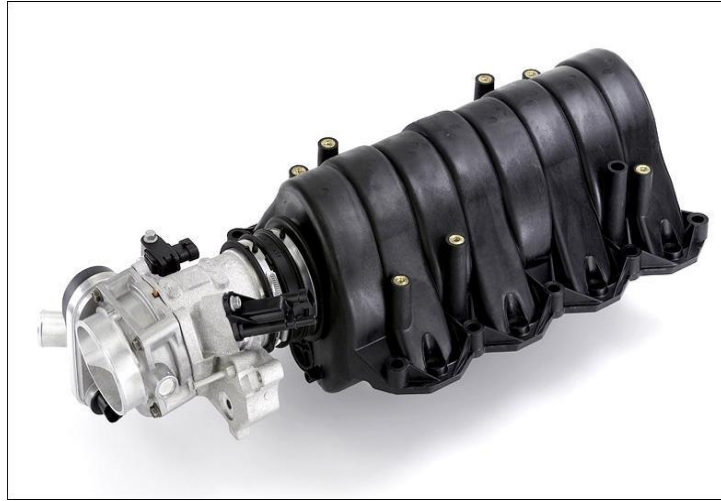
بعض السيارات الحديثة تستخدم مجمع سحب مصنوع من البلاستيك (شكل ٢١-٥)
