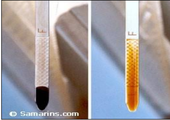
شكل (٢٠-٤) حالة الزيت
