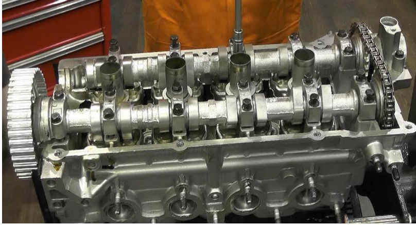
شكل (١٠-١٣) ركب عمود الكامات، مع مراعاة ضبط التوقيت بين عمودى الكامات.
