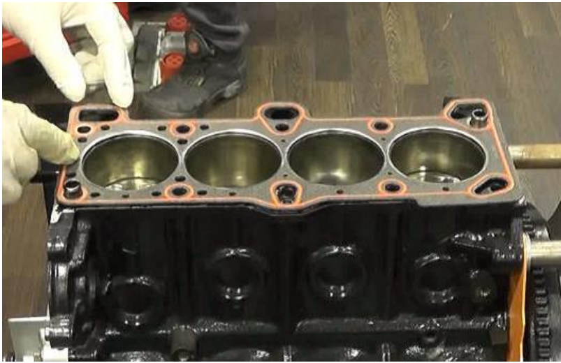
شكل (١١-١٠) ركب جوان رأس الأسطوانات بعد لف المحرك بحيث يكون الكرتير إلى أسفل.
