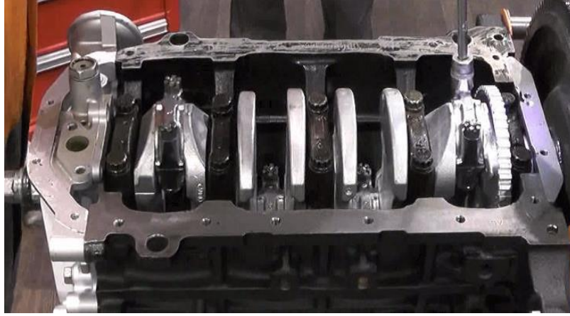
شكل (٨-١٠) ربط النهاية الكبرى لأذرع التوصيل بالعزم المطلوب
