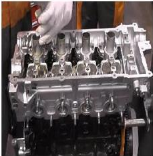
شكل (١٢-١٠) ركب رأس الأسطوانات بجسم الأسطوانات بالترتيب الصحيح للربط.
