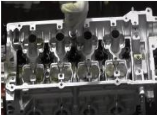
شكل (٧-٢٠) فك رأس الأسطوانات مع مراعاة الترتيب الصحيح لفك المسامير
