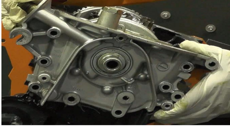
شكل (١٠-٥) ركب طلمبة الزيت
