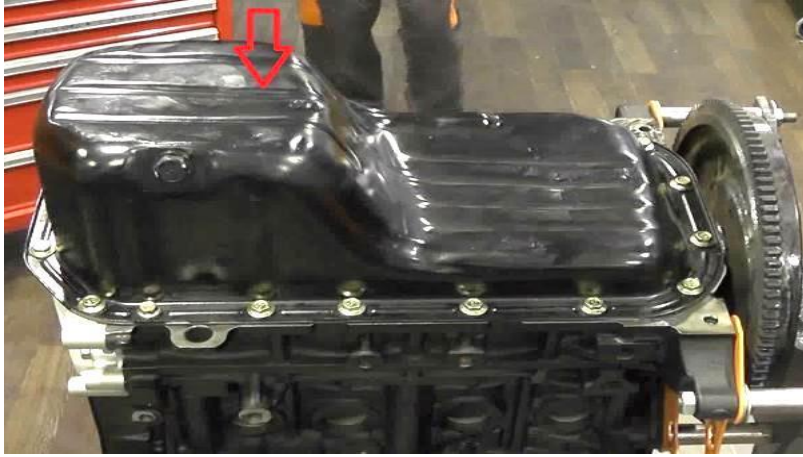
شكل (١٠-١٠) ركب خزان الزيت (الكرتير) والجوان الخاص به.
