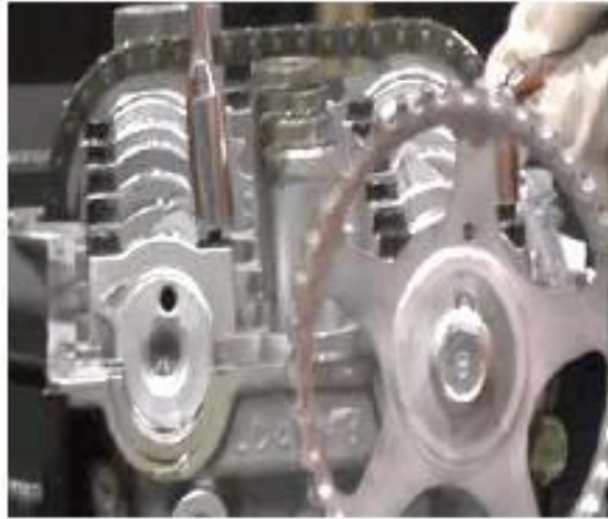
شكل (٧-١٩) فك أعمدة الكامات من خلال فك كراسي عمود الكامات مع مراعاة ترتيب الكراسي. وكذلك مراعاة علامات التوقيت بترس الكامات.
