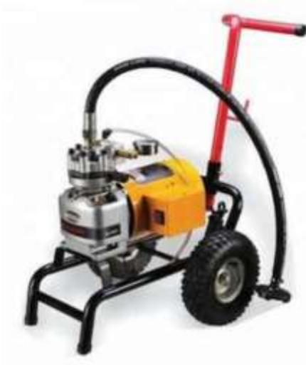
الطرد أو الراجع و يستخدم أثناء التنظيف - فتحة دخول الزيت - يد لحمل المضخة - عربة حاملة للمضخة - كابل كهربائي معزول ) .
