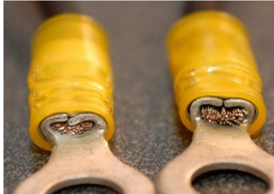
شكل (٦-٥) تم تأريج الترملة لكي تقبض على السلك وتمنعه من الحركة
