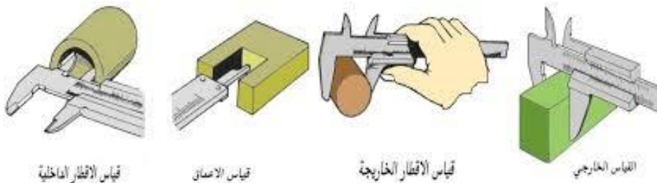
( شكل ٨-١ ) استخدامات القدم ذات الورنية في القياسات المختلفة
